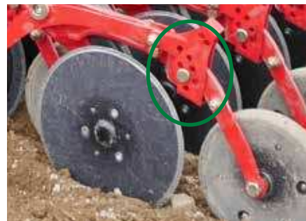
Flexible Einstellung in Schwimmposition
