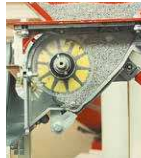
Einstellung für feines Saatgut (Kern eingeschoben)
