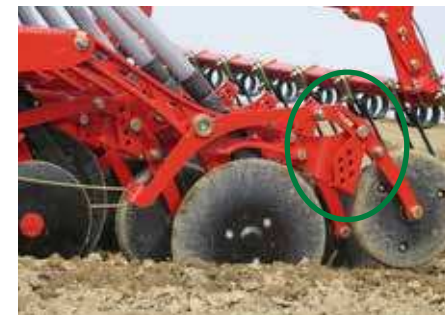
Ausgehobene Einstellung der Andruckrolle
